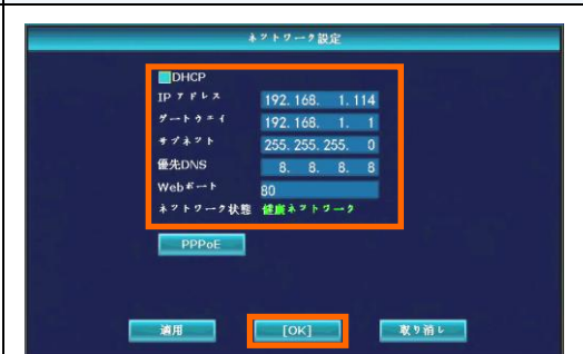
⑧ 【ネットワークに接続する場合】IP アドレス、ゲートウェイ、サブネット等を設定し、[OK] をクリックします。
